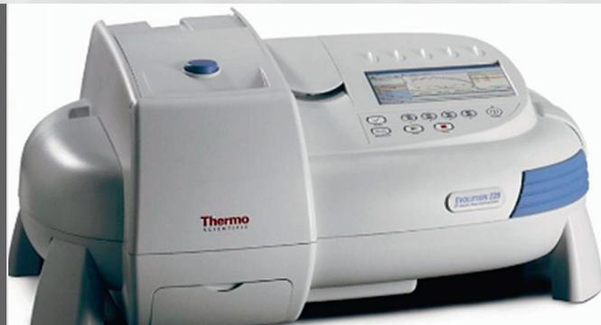
Спектрофотометр ультрафиолетового и видимого диапазона Evolution 201 (Thermo Fisher Scientific, США)
