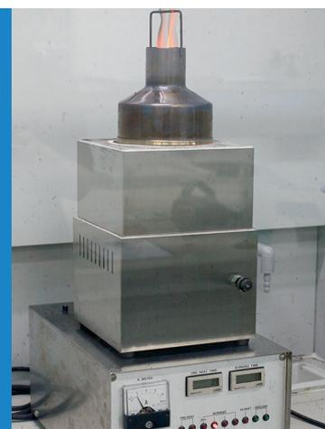
Автоматический анализатор для определения коксуемости по Конрадсону (Tapaka Scientific Limited, Япония)
