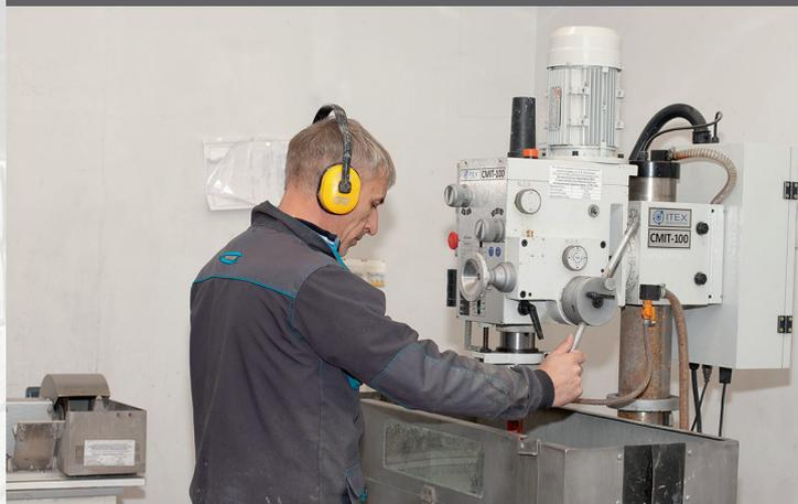
Отделение по сбору и хранению керна обладает современным камнерезным и камнеобрабатывающим оборудованием, которое позволяет изготавливать как стандартные образцы каменного материала для рутинных петрофизических исследований, так и образцы произвольной формы.
