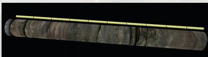
3D фото боковой поверхности колонки керна 1 м
