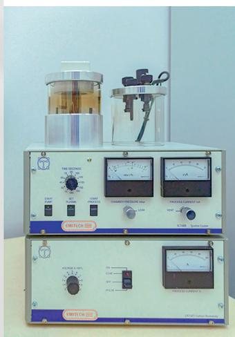
Комплекс напылительной установки EMITECH (Polaron, Англия) - для пробоподготовки - нанесение токопроводящего слоя металла на поверхность образца для качественного анализа
