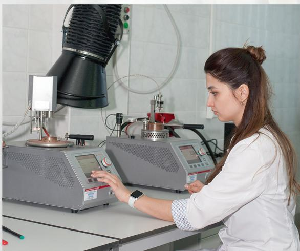
Автоматический анализатор температуры вспышки в закрытом тигле по методу Абея АВА4 (Anton Paar Provetec, Германия)
