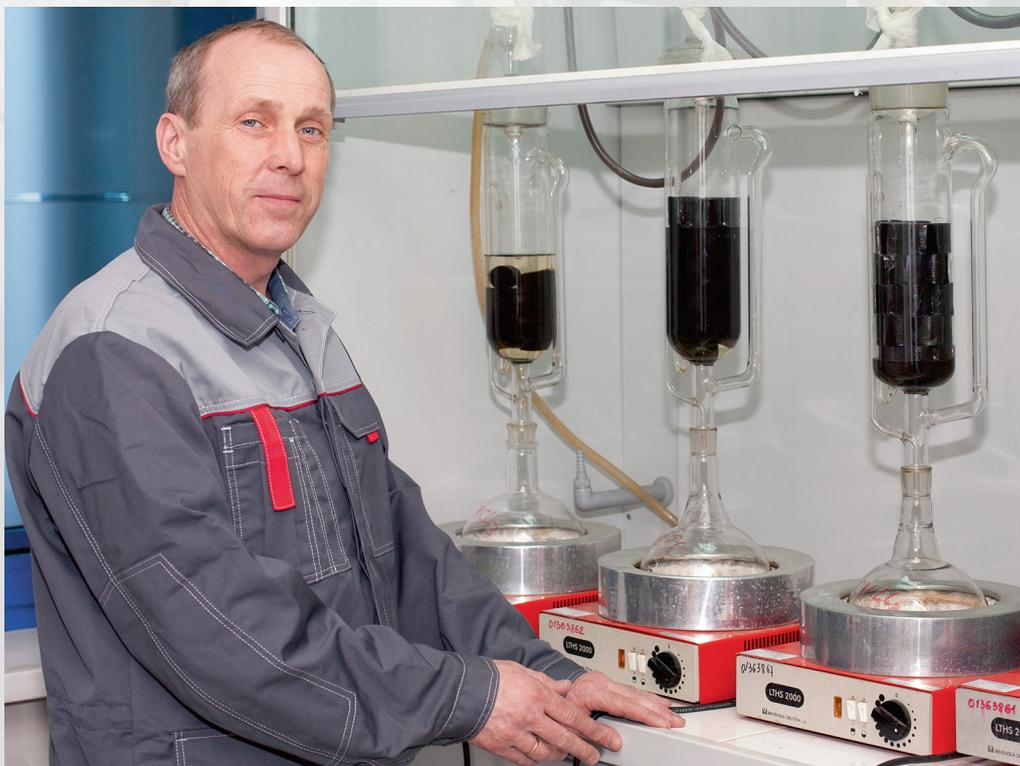
Экстракцию цилиндрических и измельченных образцов проводят органическими растворителями в аппаратах Сокслета.
