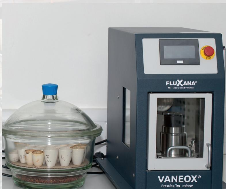
Автоматизированный пресс Vaneox (FLUXANA, Германия)
