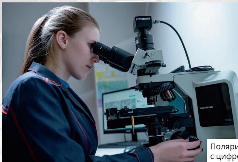
Поляризационный микроскоп Olympus BX53 с цифровой фотокамерой SIMAGIS XS-6CU
