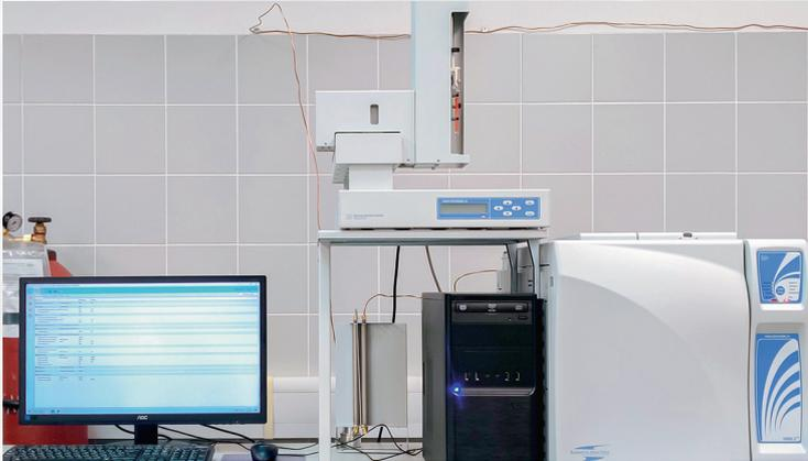
Газохроматографический комплекс на базе хроматографа «Кристалл 5000.2» производства ЗАО СКБ «Хроматек» (Россия) оснащен двумя детекторами и двумя хроматографическими колонками
