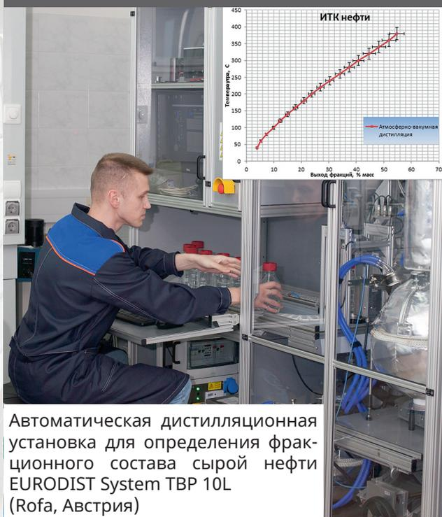
Автоматическая дистилляционная установка для определения фракционного состава сырой нефти EURODIST System TBP 10L (Rofa, Австрия)
