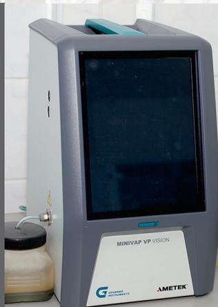
Автоматический анализатор давления насыщенных паров Minivap VP VISION (Grabner Instruments, Австрия)
