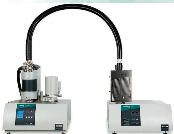
Синхронный термический анализатор NETZSCH STA 449 F3 Jupiter® комбинированный с масс-спектрометром QMS 403 (Aeolos Quadro®, Германия)
