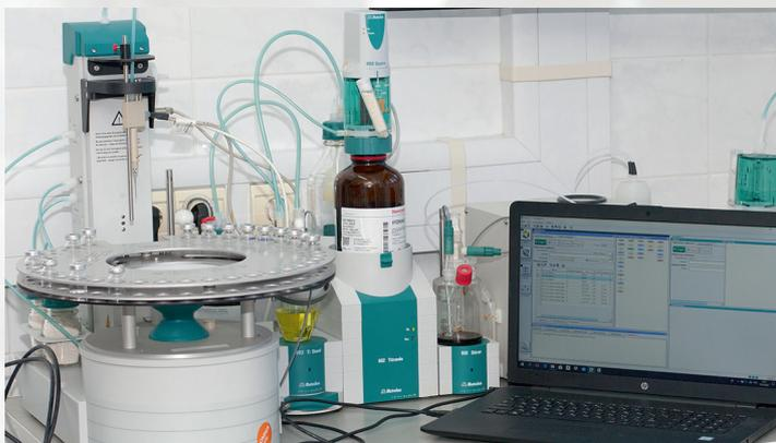
Титратор автоматический для определения содержания воды по методу Карла Фишера 852 Titrandо (Metrohm AG, Швейцария)
