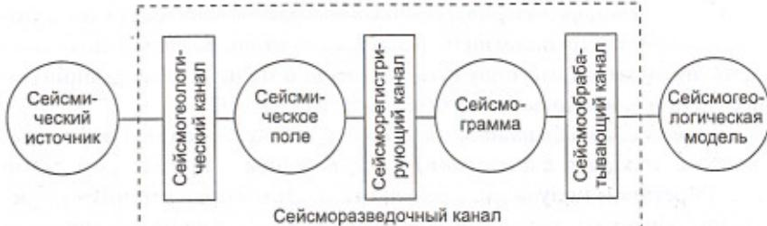
Рис. 2. Структура сейсморазведочного канала
